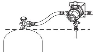
DuoControl debe montarse de modo que las conexiones de los tubos flexibles de alta presión se encuentren en la posición lo más elevada posible, como mínimo por encima del nivel de la válvula de botella (línea discontinua).
