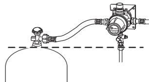
DuoControl skal monteres sådan, at højtryksslangeres tilslutninger befinder sig på den højest mulige position, som minimum over flaskeventilens niveau (stiplet linje).
