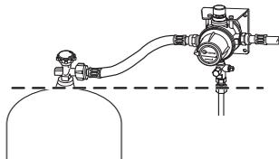
DuoControl doit être monté de telle sorte que les raccords des lyres haute pression se trouvent sur la position la plus haute possible, au moins au-dessus du niveau de la vanne de bouteille (ligne discontinue).
