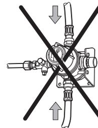
DuoControl sólo debe montarse de modo que las conexiones de los tubos flexibles de alta presión estén dispuestas **horizontalmente**.
