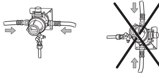
DuoControl darf nur so montiert werden, dass die Anschlüsse der Hochdruck-Schläuche **waagrecht** angeordnet sind.
