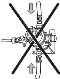
DuoControl doit être monté uniquement de telle sorte que les raccords des lyres haute pression soient disposés **horizontalement**.
