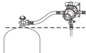
Montare DuoControl in modo che i collegamenti dei tubi flessibili ad alta pressione si trovino il più in alto possibile, come minimo al di sopra dell'altezza della valvola della bombola. (linea tratteggiata).
