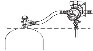
DuoControl muss so montiert werden, dass die Anschlüsse der Hochdruck-Schläuche sich an höchstmöglicher Position befinden, zumindest jedoch über dem Flaschenventil-Niveau (gestrichelte Linie).
