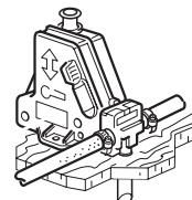
**!** Per garantire uno scarico sicuro del contenuto del boiler in caso di pericolo di gelo, sul collegamento dell'acqua calda del boiler deve essere montata una valvola di ventilazione automatica. Di serie per tutti i dispositivi acqua calda di Truma.
