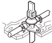
På varmeovn Trumatic C erstatter FrostControl den elektriske aktiverede sikkerheds-/aftapningsventil ELASI.
