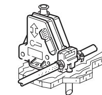
**!** Afin de garantir l'écoulement en toute sécurité du contenu du chauffe-eau en cas de risque de gel, une soupape de ventilation automatique doit être montée sur le raccord d'eau chaude du chauffe-eau. De série sur tous les appareils de préparation d'eau chaude Truma.
