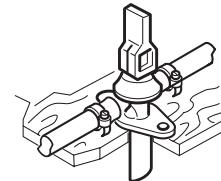
Nella stufa Trumatic C, FrostControl sostituisce la valvola di scarico di sicurezza ad azionamento elettrico ELASI.
