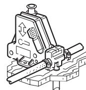
**!** For at muliggøre en sikker aftapning af vandvarmerens indhold ved frostfare, skal der være monteret en automatisk ventilationsventil på vandvarmerens varmtvandstilslutning. Standard på alle varmtvandsapparater fra Truma.
