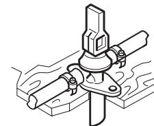
En la calefacción Trumatic C, el FrostControl sustituye la válvula de seguridad/purga eléctrica ELASI.
