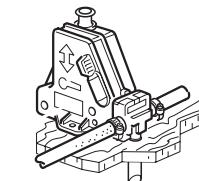
**!** Om een veilig leegstromen van de boilerinhoud bij vorstgevaar mogelijk te maken, moet aan de warmwateraansluiting van de boiler een automatisch ventilatieventiel gemonteerd zijn. Standaard bij alle warmwateroestellen van Truma.
