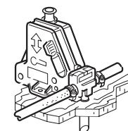
**!** Para permitir que el contenido del calentador se evacúe de forma segura en caso de peligro de heladas, en la conexión de agua caliente del calentador debe montarse una válvula de aireación automática (de serie en todos los calentadores de agua Truma).
