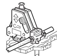
**!** Um ein sicheres Ablaufen des Boilerinhalts bei Frostgefahr zu ermöglichen, muss am Warmwasserschluss des Boilers ein automatisches Belüftungsventil montiert sein. Serienmäßig bei allen Warmwassergeräten von Truma.
