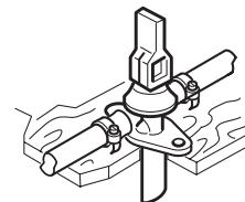
Pour le chauffage Trumatic C, la soupape FrostControl remplace la soupape de sûreté/de vidange électrique ELASI.
